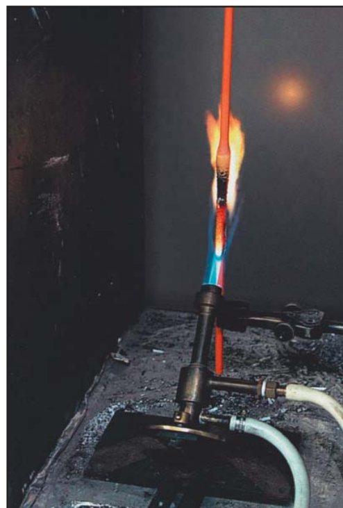
Испытание на огнестойкость согласно IEC 60332-1. Длина образца кабеля = 60 см. Максимальное допустимое распространение огня = 45 см.
