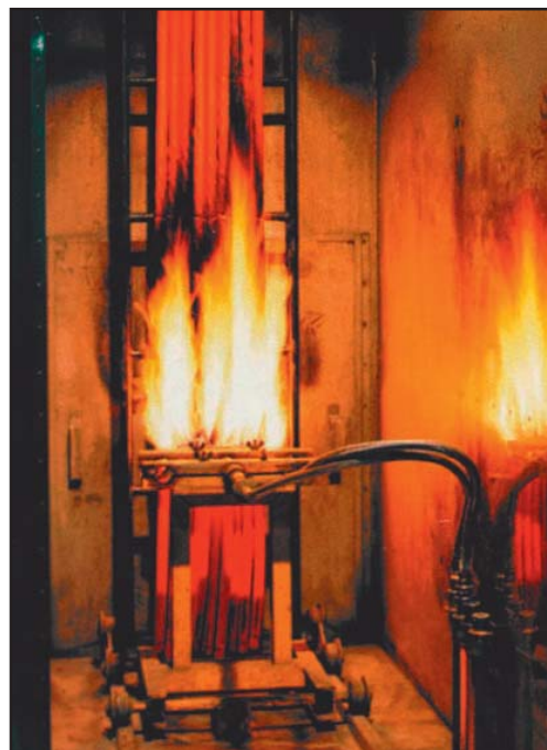
Испытание на огнестойкость согласно IEC 60332-3. Кабель установлен на вертикальной лестнице.
